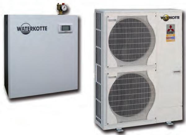
4. **WP QL K**, Kaskaden-Gerät, für höhere Leistungen (bis 56 kW) zur Verbindung mit bis zu 4 Außengeräten. Eingebaut sind die Wärmeaustauscher, die elektrischen Steuerungen, je Außenteil eine Umwälzpumpe, ein gemeinsamer Luftabscheider mit automatischem Luftableiter, bauteilgeprüftes Sicherheitsventil und Fülldruckmanometer so wie eine 6 kW E-Heizung.
